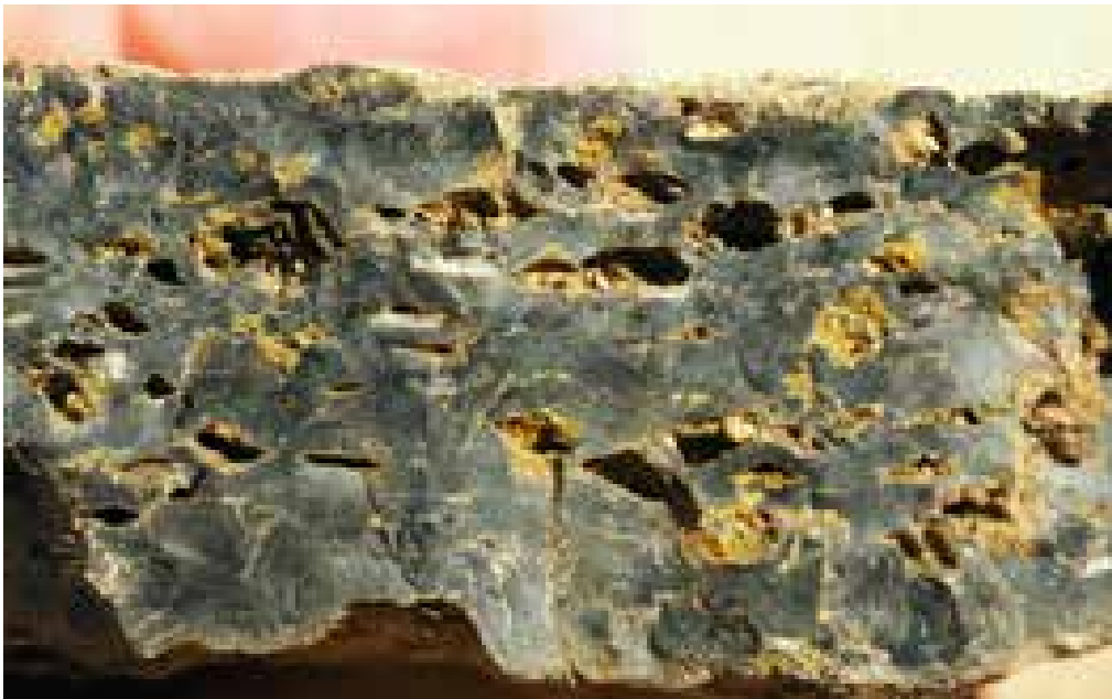
Capa vítrea exterior de una bola de acreción (espesor: 4 cm)
